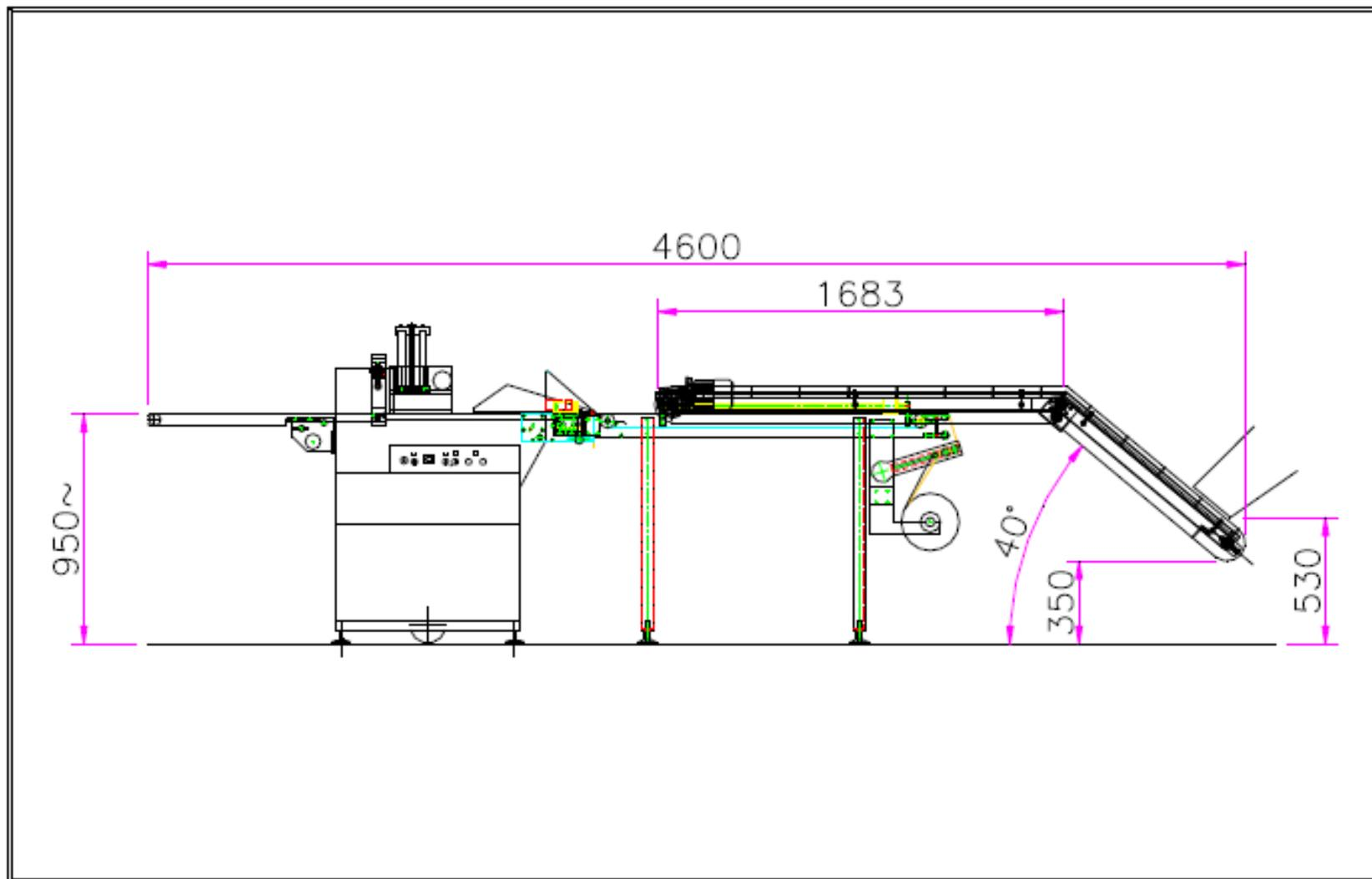
Figure 3 - Vues latérales ensacheuse Micropac Intermittente 1751
